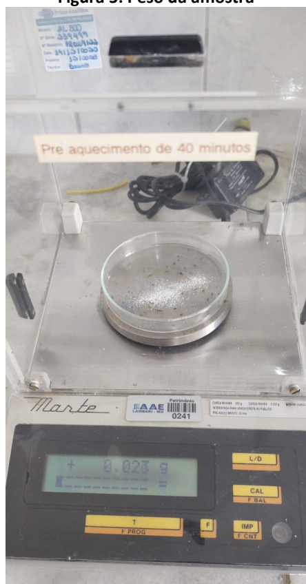
Figura 6: Peso da amostra para verificação de cloro livre
